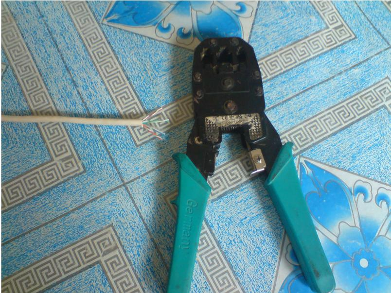
2. Kupas kabel dan atur susunan seperti yang diinginkan (Straight atau CrossOver)
